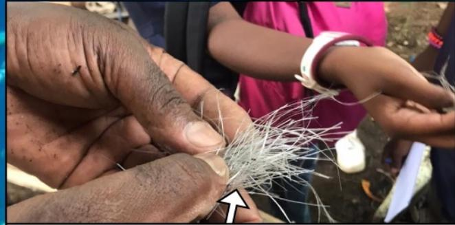
UN MÉLANGE DE FIBRE, DE RÉSINE ET DE COLLE SERT À RÉALISER LA COQUE SUR LE MOULE.
