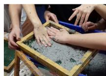
**Etape 4.** Plonger le cadre avec le tamis dans le mélange pour le recouvrir d'une couche de pâte régulière et la plus fine possible.
