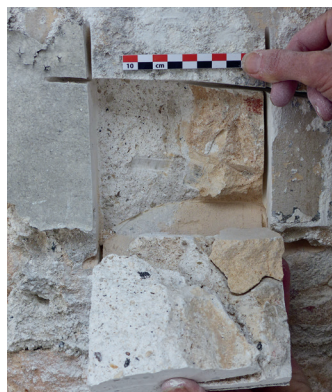
Prélèvement d'enduit au plâtre au Théâtre de la Renaissance à Paris
